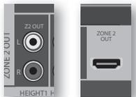
Il connettore HDMI di uscita Z2 può essere utilizzato per collegare l'uscita dell'AVR ad un sistema situato in una seconda stanza.
