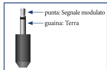
Gli ingressi infrarossi (**Z1 IR** e **Z2 IR**) consentono il collegamento di ricevitori IR esterni, sia quando il ricevitore IR del pannello anteriore AVR è completamente o parzialmente ostruito o per consentire l'utilizzo di un telecomando in Zona 2.
