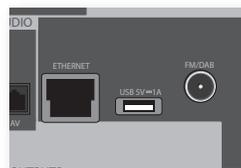
L'AVR è dotato di un client audio di rete che è in grado di riprodurre stazioni radio Internet così come la musica memorizzata su un dispositivo di archiviazione di rete, ad esempio un PC o un'unità flash USB.
