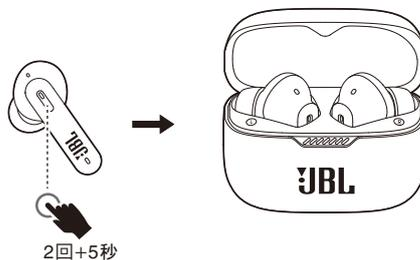
リセットが完了すると、イヤホン本体の Bluetooth インジケーターが点滅し、ペアリング待機状態になります。
