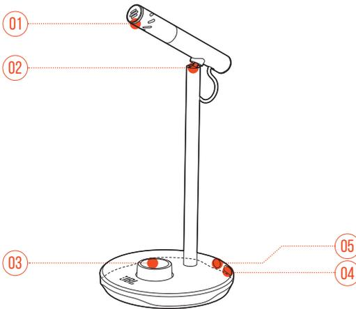
01 リングLED（ミュート/ミュート解除/音量インジケーター）
