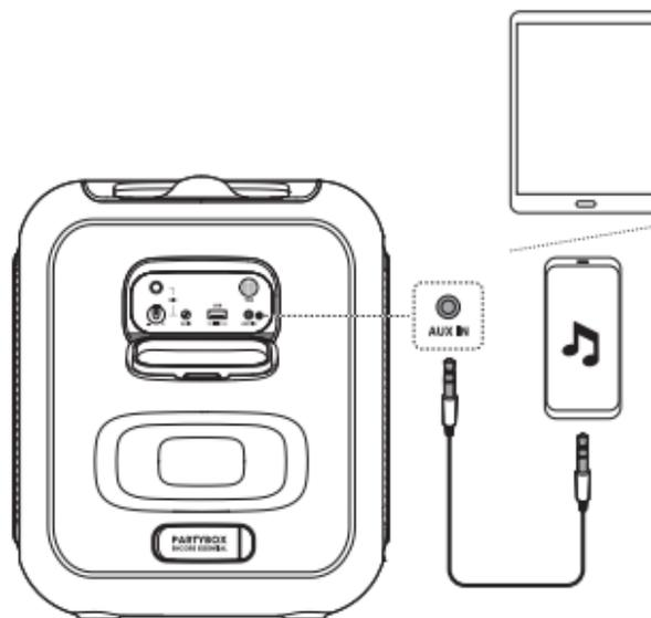
1. Conecte um dispositivo de áudio externo ao alto-falante por meio de um cabo de áudio de 3,5 mm (não fornecido).
