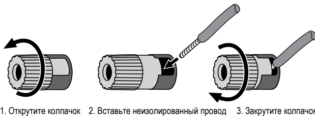
1. Открутите колпачок 2. Вставьте неизолированный провод 3. Закрутите колпачок
